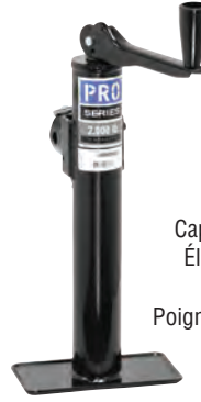
D1401020303 Capacité/Capacity: 2,000 lb. Élévation/Lift: 10 4/10" à/to 20 4/10" Course/Travel: 10" Poignée sur le côté / Sidewind
