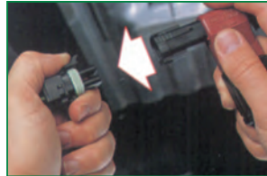
Rebranchez les fils au connecteur en "T" Reconnect the wires to the "T" adaptor
