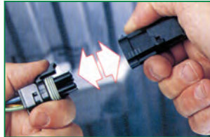
Débranchez les fils sous le véhicule Disconnect the wires under the vehicle
